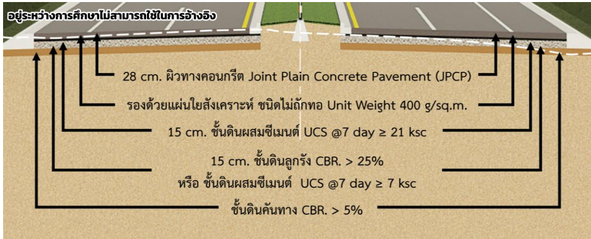
รูปที่ 9-4 รูปตัดแสดงการออกแบบโครงสร้างชั้นทาง
