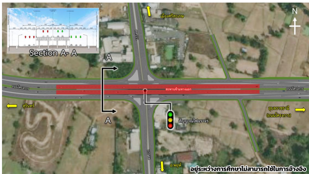
รูปที่ 9-8 รูปแบบจุดตัดทางแยกต่างระดับบริเวณจุดตัดทางหลวง บนทางหลวงหมายเลข 221
