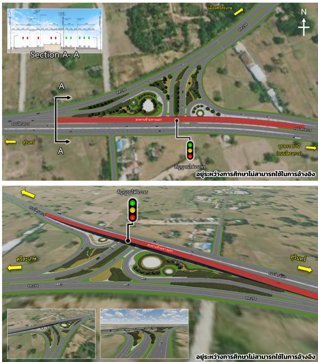
รูปที่ 9-6 รูปแบบจุดตัดทางแยกต่างระดับบริเวณจุดเริ่มต้นของโครงการ บนทางหลวงหมายเลข 294
