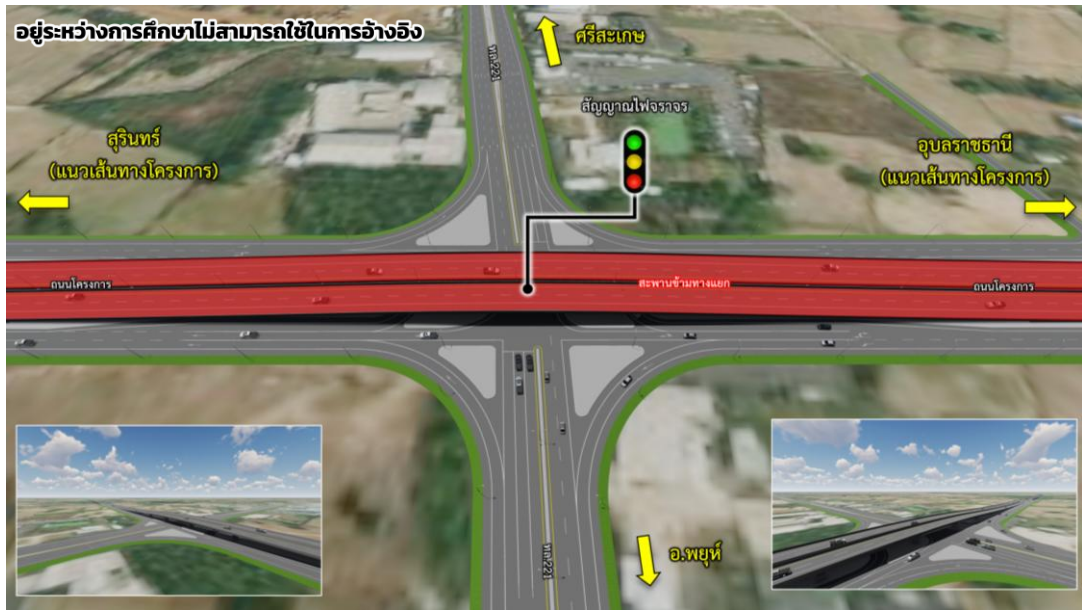
รูปที่ 9-8 รูปแบบจุดตัดทางแยกต่างระดับบริเวณจุดตัดทางหลวง บนทางหลวงหมายเลข 221 (ต่อ)
